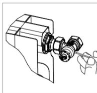
Nel caso di valvola con protezione da cantiere, dopo aver svitato in senso antiorario il cappuccio rosso, sganciare la protezione da cantiere facendo leva sulla base mediante l'ausilio di un cacciavite.
