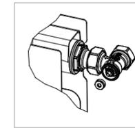
In caso di manutenzione è possibile sostituire l'anello O-ring dell'asta svitando la calottina del vitone mediante l'ausilio di una chiave esagonale da 11 mm. Questa operazione può essere effettuata anche ad impianto funzionante.
