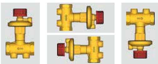
Установите клапан R206C-1 на обратном трубопроводе в соответствии с направлением потока, показанным на корпусе клапана, и подсоедините его к подающей магистрали капиллярной трубкой. Рекомендуем установить запорный клапан на входе и выходе, в дополнение к фильтру для предотвращения загрязнения. Клапан R206C-1 может быть установлен в любом направлении (горизонтально и / или вертикально).
