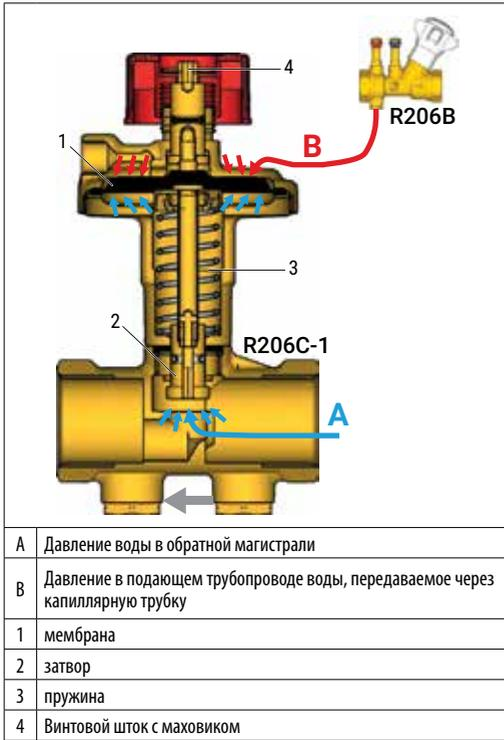
Гидравлический контур управляется двумя клапанами объединенными капиллярной трубкой: статическим балансировочным клапаном (R206B) и регулятором перепада давления (R206C-1).
