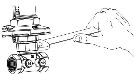
Перед опрессовкой и запуском системы необходимо удалить воздух из полости фланца мембрани. Отвернуть винт штуцера воздухоотвода шестигранником 5 мм до полного удаления воздуха и закрутить винт в первоначальное положение. Затем установить импульсную трубку соединив регулятор перепада с регулятором расхода (R206С и R206В).
