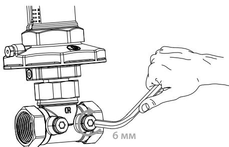
Для удобства монтажа в случае необходимости можно изменить ориентацию штуцера импульсной трубы относительно оси клапана. Ослабить гайку на корпусе клапана с помощью шестигранного ключа, повернуть корпус ориентируя штуцер в нужное положение. Затянуть ослабленную гайку.
