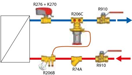
В конструкции клапана предусмотрена возможность установки измерительных ниппелей (P206Y001) и подключения дифференциального манометра для измерения гидравлических характеристик и настройки системы. Для этого выкрутить две красные пробки шестигранником 6 мм и установить на их места ниппели (красный со стороны входа жидкости, синий со стороны выхода).
