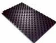
Панель изоляционная преформованная для систем напольного отопления, из вспененного полистирола с графитом. Шаг укладки 50 мм. Для трубы диам. 16-18 мм. Эффективный размер 1400x800 мм.
